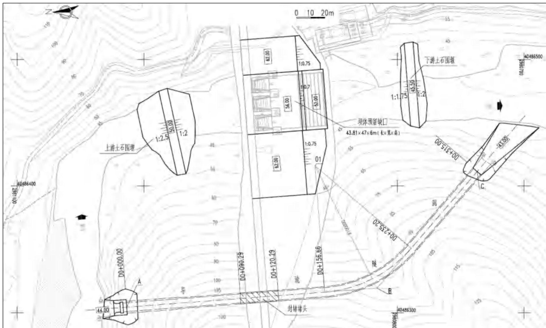
图 2.8-1 施工导流平面布置图
